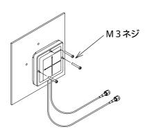
図 2-8: 平面アンテナの固定
