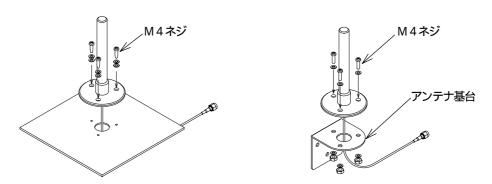
図 2-7: つば付きアンテナの固定
