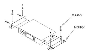
図 2-2: 取り付け金具を使用する
