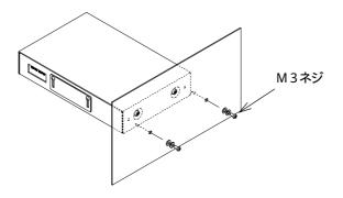
図 2-3 機器に直接取り付ける
