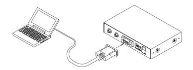
図 2-4: RS - 232 Cケーブルの接続
