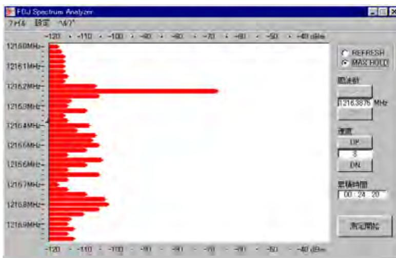
図5：簡易スペクトルアナライザーによる観測例
